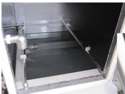
※マイクロバブルを発生させる事により、タンク内の水は乳化します。
